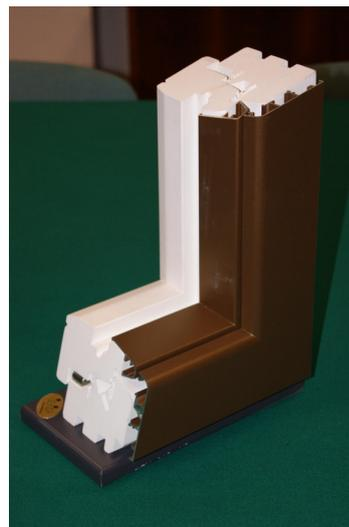
Ante con telaio strutturale di sezione 66 mm (larghezza) x 92 mm (spessore) con componenti incastrati con sistema di giunto a "tenoni". Fermavetri interni di profondità adattata allo spessore della vetrata inserita. Tamponamento delle ante vetrate con vetrata isolante a singola o doppia camera.
